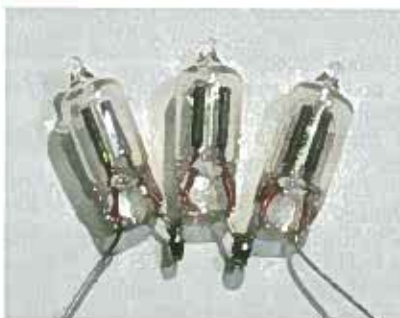
Obr. 3. Detail doutnavek zapojených v sérii
