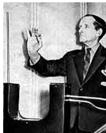
Obr. 140. Skutečné provedení hudebního nástroje Theremin. Vlevo je svislá anténa pro ovládání výšky tónu (PITCH), vpravo je vodorovná anténa pro ovládání hlasitosti (VOLUME)
